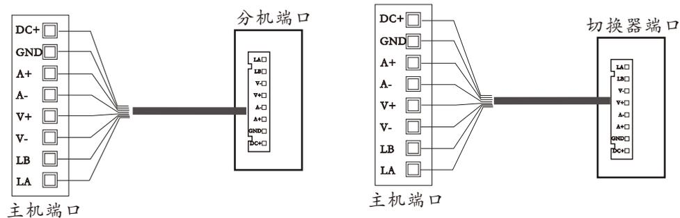
信号开锁接线(注:需由外接电源供电)
