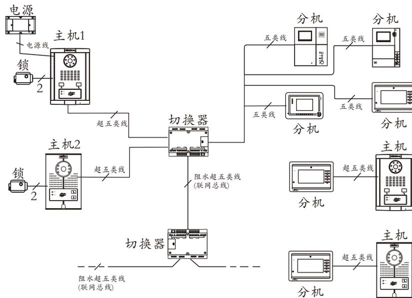
【注】1、当接分机时，只能接总线制分机，而且可带多台。
