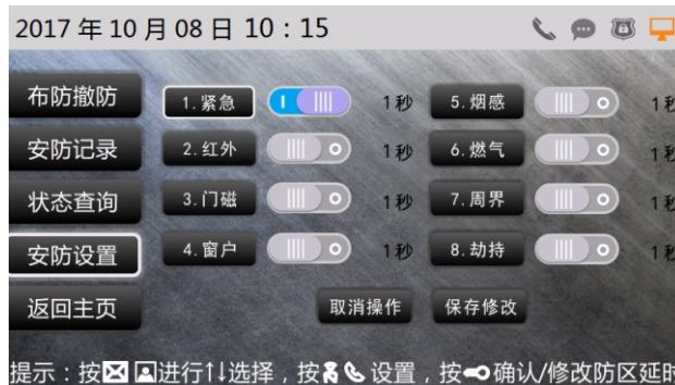
根据下方提示选择相应的探头后按确认。可设定防区延迟报警时间，最大值999秒。
