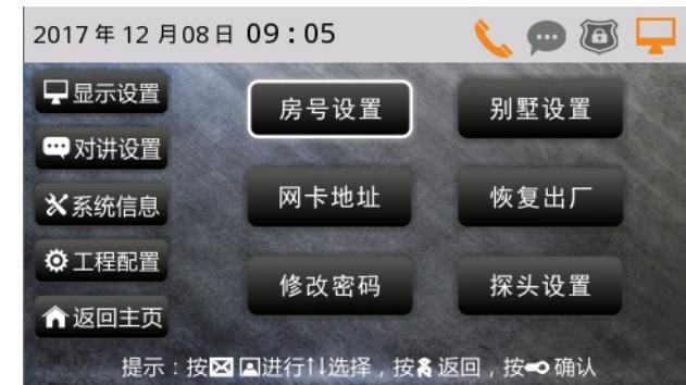
进入设置界面，有六个操作可供选择：房号设置，别墅设置，网卡地址，恢复出厂，修改密码及探头设置。
