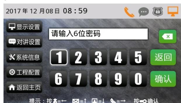
工程配置：进行一些必要的参数配置。输入密码（默认666666），点击确认按钮，进入设置页面。
